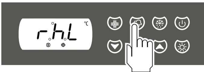
zeigt an, ob die Maschine in hoher oder niedriger relativer Luftfeuchtigkeit arbeitet
